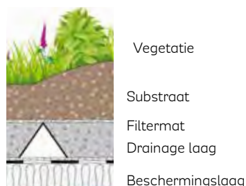
Schematische doorsnede natuurdak ©Optigroen
