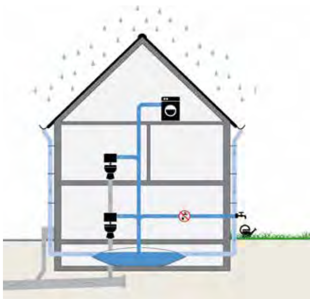
Schematische doorsnede regenwatergebruik-systeem met waterzak © Atelier GROENBLAUW
