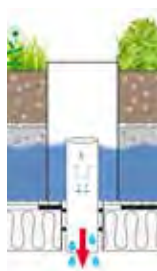
Schematische doorsnede retentiedak ©Optigroen
