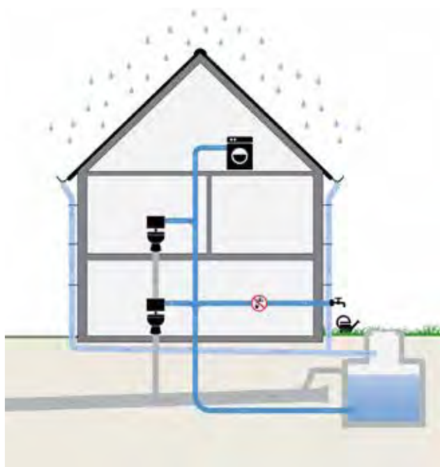
Schematische doorsnede regenwater-gebruikssysteem © Atelier GROENBLAUW
